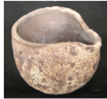
Gambar 7. Kowi untuk menuang logam cair
